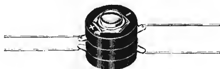
Fig. 13 — Modello di raddrizzatore a ponte per strumenti di misura: a volte ha anche forma rettangolare.
