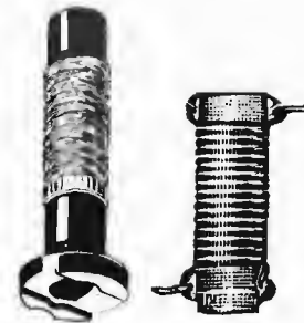
Fig. 5 — Supporti in bachelite; sul primo è visibile un avvolgimento del tipo detto a « nido d'ape »; il secondo supporto presenta una scanalatura a spirale per accogliere il filo.
