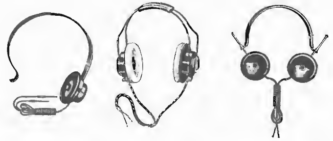
Fig. 17 — Tipi vari di cuffie. Questi riproduttori del suono possono essere anche monoauricolari, per dar modo a chi ascolta di udire anche i suoni dell'ambiente. Possono essere magnetiche, dinamiche, piezoelettriche: vedremo più avanti tali differenze.
