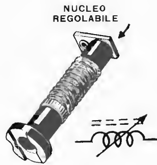
Fig. 19 - Bobina del tipo detto « a nido d'ape », con nucleo regolabile e supporto per il montaggio.
