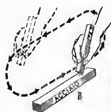
Fig. 2B - Sistema di magnetizzazione per contatto con un altro magnete.
