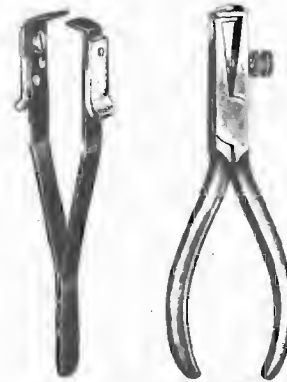
Fig. 9 - Due pinze spellafili. Predispongono i fili isolati, mettendo a nudo la parte metallica.
