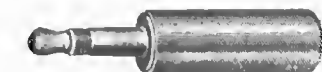
Fig. 19 - Presa per spinotti a « jack ». Vi sono vari tipi, con o senza chiusura o apertura automatica di circuiti.
