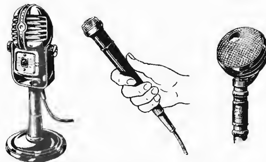
Fig. 5 C — Aspetto di tipici microfoni a cristallo disponibili in commercio. Il primo è munito di controllo di volume. Il secondo può essere comodamente tenuto in mano.
