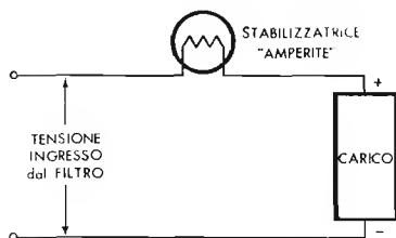
Fig. 2 — Qui R è rappresentata da una lampada « Amperite » che varia la sua resistenza in rapporto alla corrente che la percorre, per cui si oppone alle variazioni della tensione entrante.
