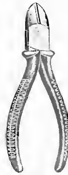
Fig. 3 - Il «tronchesino» che, come dice il nome, serve a troncare i conduttori.
