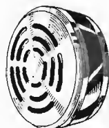
Fig. 5 B — Aspetto tipico di una capsula microfonica piezoelettrica. Viene installata in un apposito involucro.
