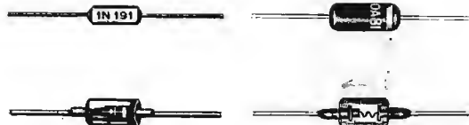
Fig. 14 — Tipi diversi di diodi rettificatori per Alta Frequenza. In tutti è presente un contrassegno (spesse volte una striscia) che indica il lato o « elettrodo » positivo.
