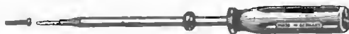
Fig. 8 - Cacciavite di particolare impiego per collocare viti in posizioni non accessibili correntemente: stringe le viti sino a che non viene liberata dall'operatore.
