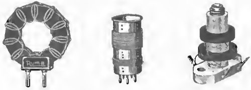
Fig. 16 — Le bobine di induttanza possono assumere forme diverse. A sinistra una bobina cosiddetta a « nido d'ape », oggi non più usata; in centro una bobina intercambiabile; a destra bobine con nucleo regolabile.
