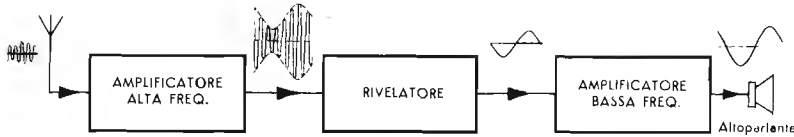
Fig. 4 - Il più semplice ricevitore è quello che svolge la sola funzione di rivelazione dell'energia captata a mezzo dell'antenna.
