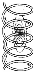
Fig. 15 - Un conduttore avvolto a spire affiancate determina un campo magnetico più intenso in quanto i singoli campi delle varie spire si sommano integrandosi a vicenda.
