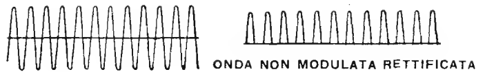
Fig. 10 - Rappresentazione della rivelazione o rettificazione di un'onda non modulata. Le semi-onde negative vengono soppresse completamente.
